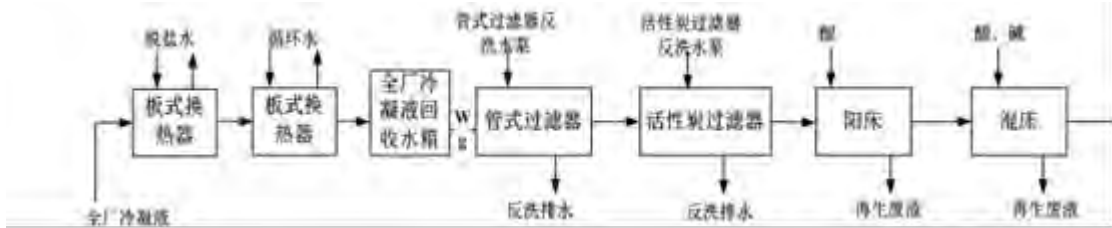
图 4.1.2-1 凝结水站流程图
