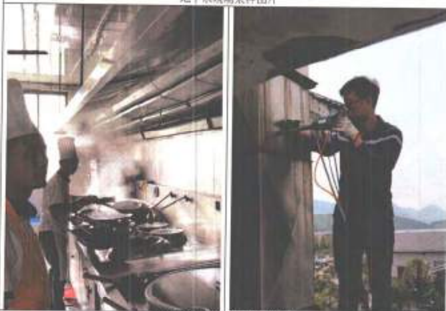
现场有组织废气油烟采样图片
