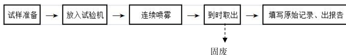
图 5-17 腐蚀试验工艺流程及产污环节图
