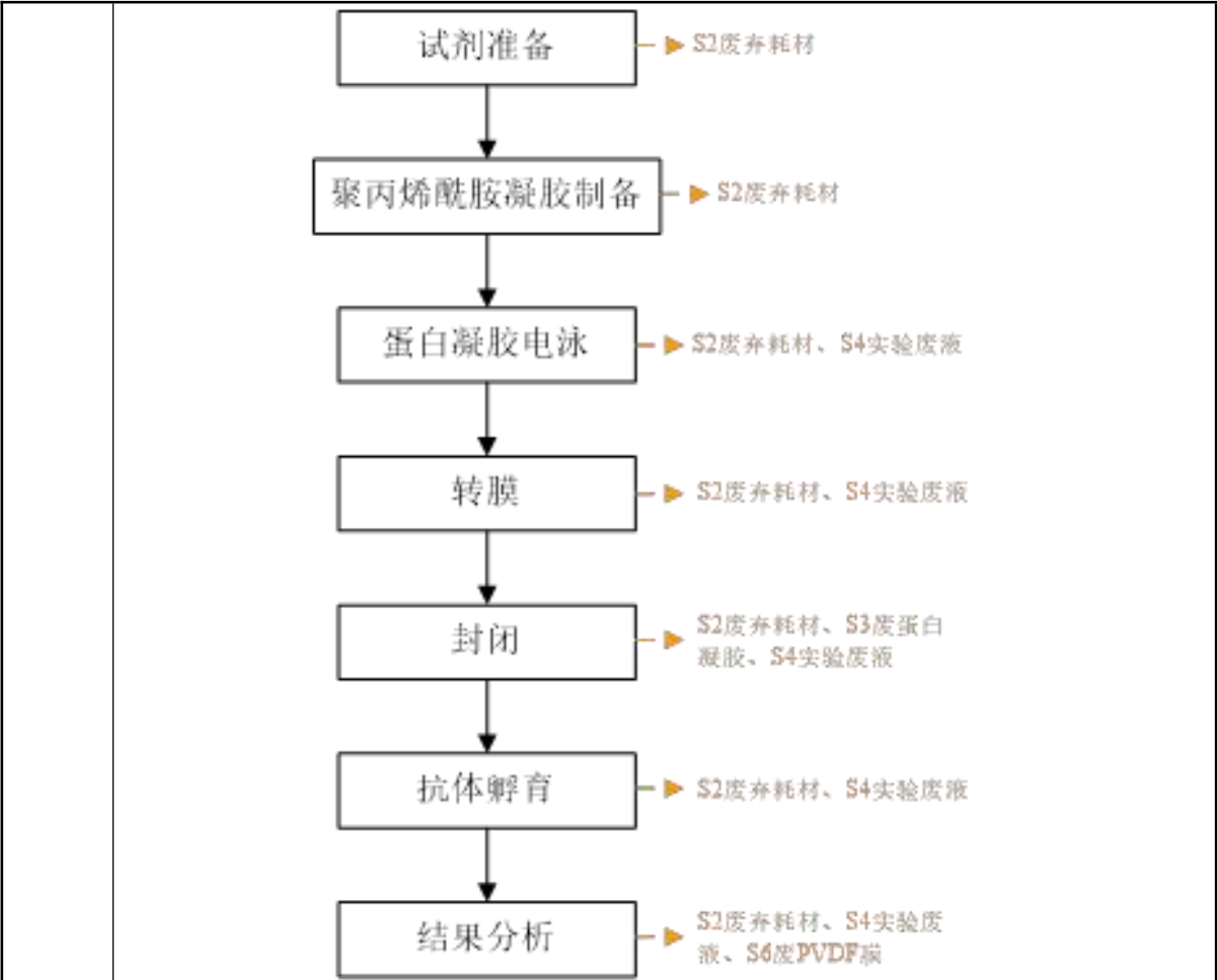
图 2-9 蛋白凝胶电泳实验流程及产污环节
