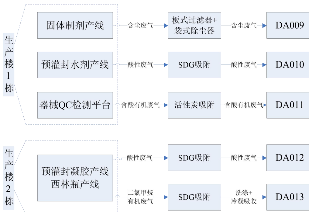
图 5.2-1 本项目生产楼废气收集及处理示意图
