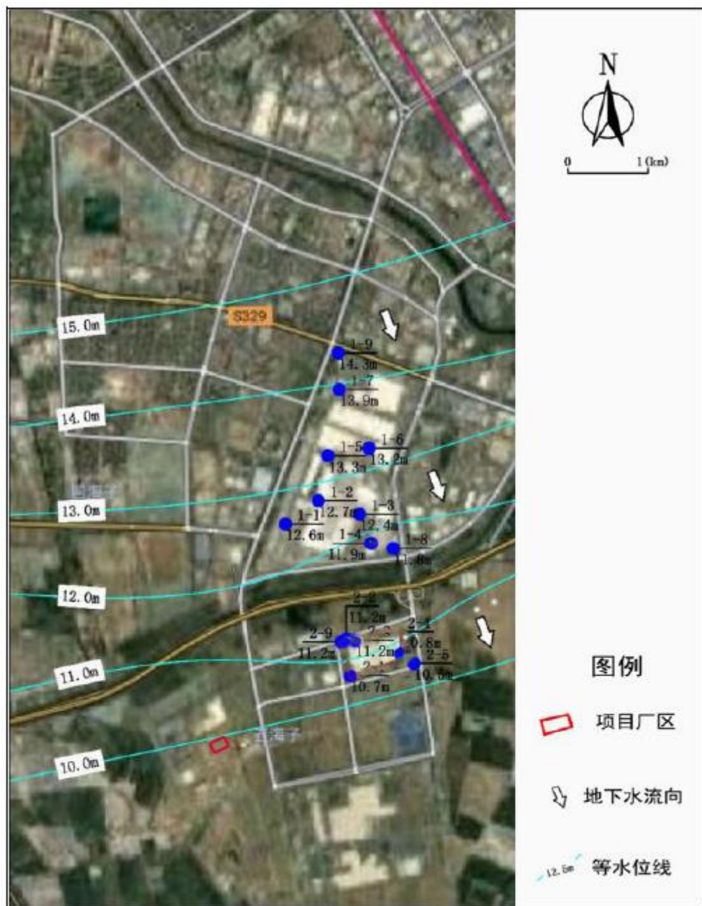
图 4.2-5 项目区域地下水等水位线图
