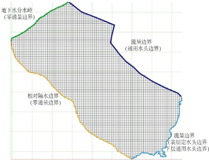
图 5-3 模拟区网格平面剖分图
