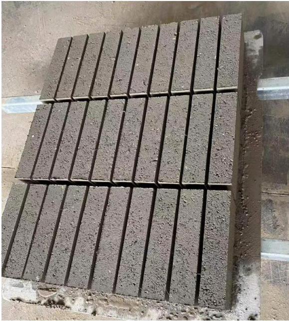
图 3- 1 飞灰预处理产物制免烧砖
